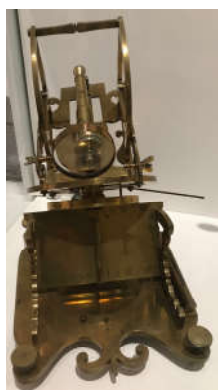
Rousseau, Cadran équinoxial avec canon de midi et cadran polaire universel , 1783, Acier, alliage cuivreux, verre
